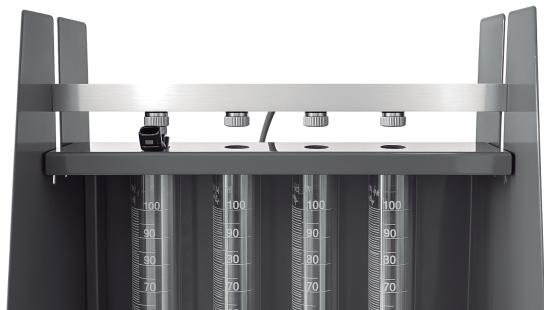
El travesaño donde se apoyan los inyectores, ubicado en la parte superior de las probetas, cuenta con dos adaptadores de chapa. Uno con orificios de **16,5 mm**, y otro con orificios de **10,75 mm**.
